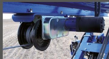
LEVAGE HYDRAULIQUE DU CHARIOT.
