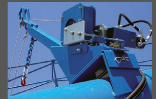
LEVAGE HYDRAULIQUE DE LA TRÉMIE.
